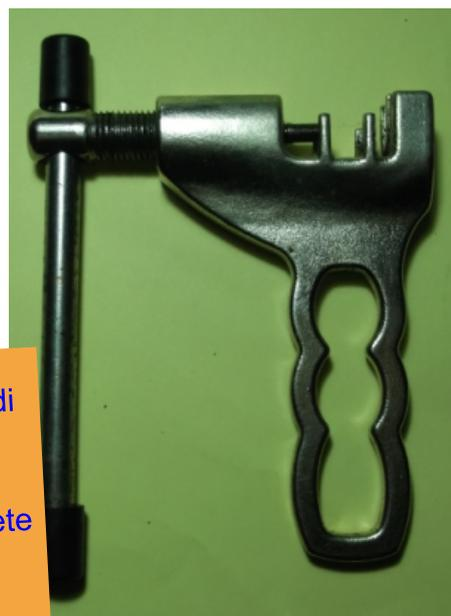
Importante da portare con se durante una uscita. Smagliacatena, falsamaglia oppure qualche cm di catena. Se durante una uscita vi si rompe improvvisamente la catena, non avendo a disposizione questo attrezzo difficilmente tornerete a pedalare. Una volta effettuata la riparazione, ricordarsi di sostituire la catena con una nuova.
