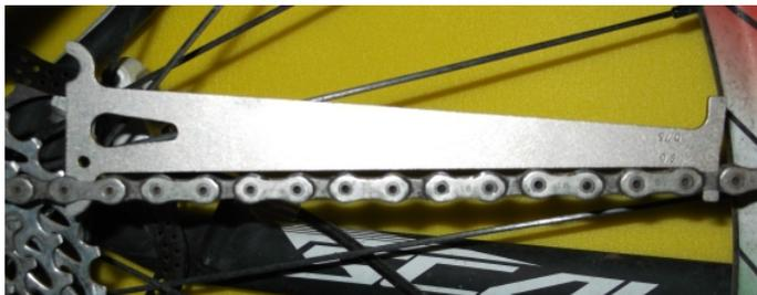
Il calibro entra a 0,5 e dobbiamo pensare di sostituire la catena
