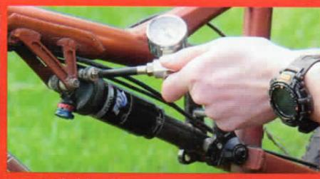
Le sospensioni dovrebbero essere sempre regolate con un "sag" corretto che garantisca la massima aderenza delle ruote sulle sconessioni del percorso. Stesso discorso per il "rebound", ovvero la rapidità d'estensione della molla, cruciale in caso d'impatti ad alta frequenza. In generale, le sospensioni devono cercare di garantire che le ruote stiano a contatto del terreno il più possibile, massimizzando trazione e direzionalità.
