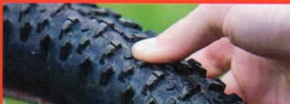
Regolate la pressione delle gomme a seconda del terreno e del meteo. Meglio avere una pressione leggermente minore sull'anteriore rispetto al posteriore, soprattutto sul bagnato. Utilizzate pure il fido "pollicione" per testare la pressione: dovrebbe affondare più davanti che dietro, ma ovviamente senza rischiare di toccare il cerchio.
