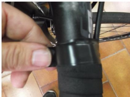
Via il nastro adesivo, srotoliamo il vecchio nastro fino ad arrivare ai tappi del manubrio, tiriamo via gli stessi ed eliminiamo l'ultima parte di nastro. In corrispondenza
